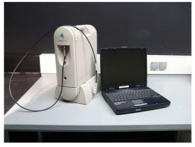
Spettroradiometro portatile per misure di campo (intervallo spettrale 350-2500 nm)
